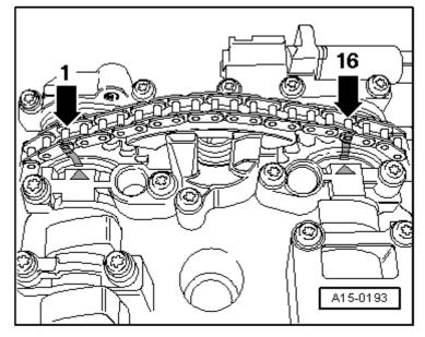
Secure camshaft adjuster using -3366-.
